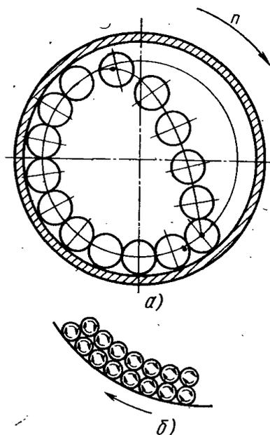
**Рисунок 14 - Схема движения шаров в шаровой мельнице:**
