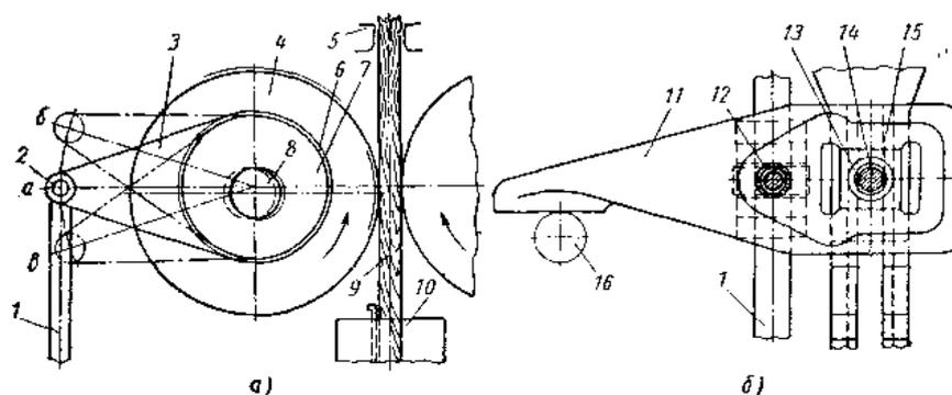
**Рисунок 16 - Распределительный механизм молота с доской:**
