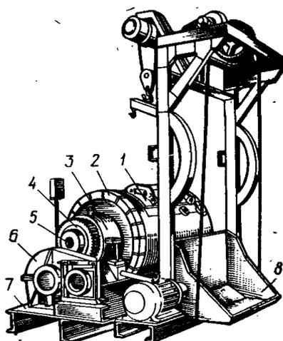
Рисунок 6 - Очистной галтовочный барабан периодического действия
