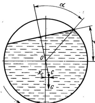
Рисунок 7 - Схема для расчета мощности привода галтовочного барабана периодического действия
