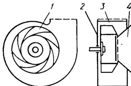
Рисунок 8 - Схема центробежного вентилятора
