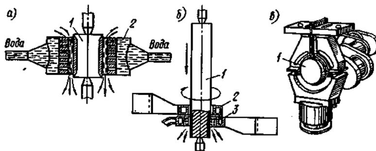
**Рисунок 3 - Поверхностная закалка деталей токами высокой частоты:**
